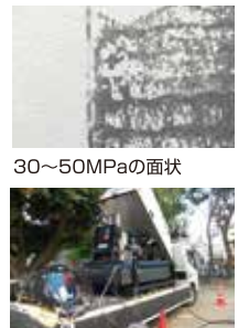
30～50MPaの面状 エコサーモ800機材全景
